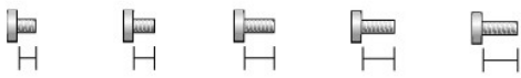
M2 x 3 mm M2.5 x 4 mm M2.5 x 5 mm M2.5 x 6 mm M2.5 x 8 mm
